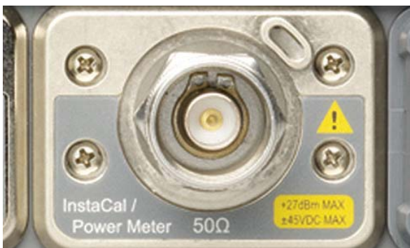
Вид с увеличением верхней панели прибора, демонстрирующий встроенный модуль InstaCal
