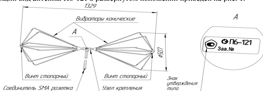
Рисунок 1 – Общий вид антенны Пб-121 в развёрнутом положении.
