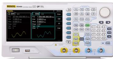
Генератор сигналов **DG4202** поддерживает следующие функции: генератор функций, генератор сигналов произвольной формы, генератор импульсов, генератор гармоник, аналоговый / цифровой модулятор, частотомер и т.д. Модель имеет 2 канала с одинаковыми функциями и регулировку фазы между каналами.
